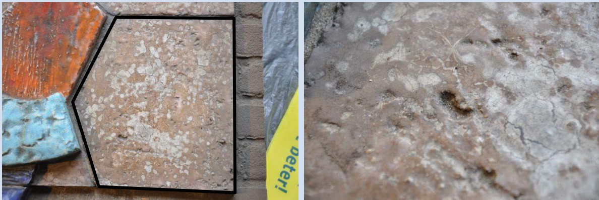
detail oppervlakte met glazuurlacune door maakproces
